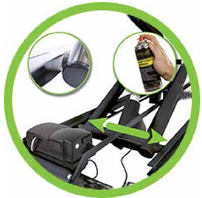
Haftschrnierfett in die untere Laufschiene
